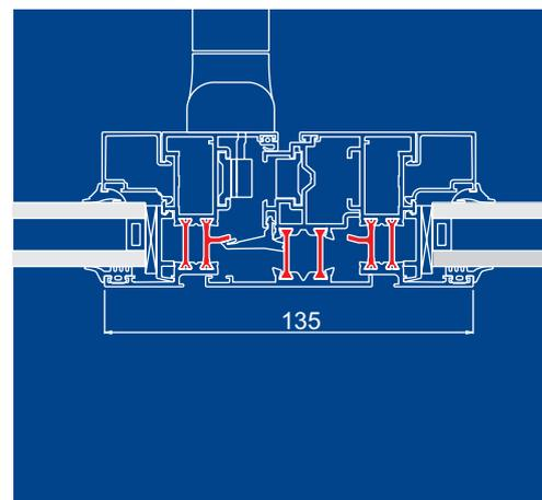
La gamme à rupture de pont thermique TS 57, pour fenêtres et portes-fenêtres, tient très largement compte des désirs des architectes et des designers en ce qui concerne la liberté de formes et de couleurs.
